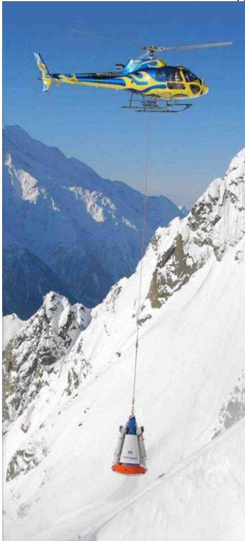
Рисунок 5.1 – Система «DAISY BELL» во время принудительного спуска лавин
